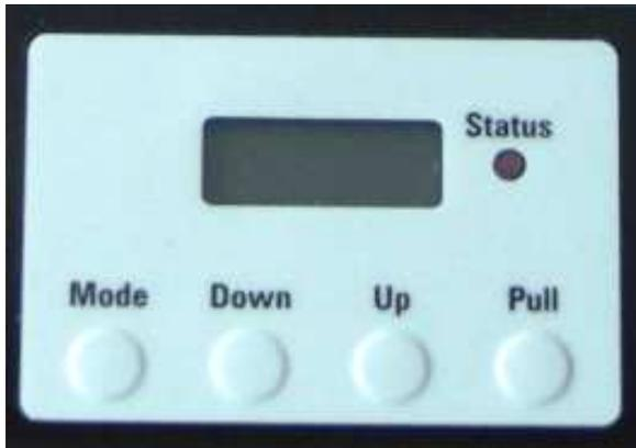
Das weiße Bedienfeld des ALF12 verfügt über ein siebenstelliges LCD-Display, eine rote Leuchtdiode „Status“ und die vier Tasten:
