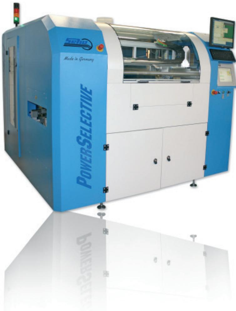
eigentliche Funktion der Mikrotropfendüse, sondern misst während des Fluxprozesses die tatsächlich aus der Düse austretende Flussmittelmenge. Abweichungen von einem zuvor festgelegten Referenzwert werden sofort festgestellt und über die Software wird zudem angezeigt, an welcher Stelle der Baugruppe nicht exakt gefluxt wurde.
