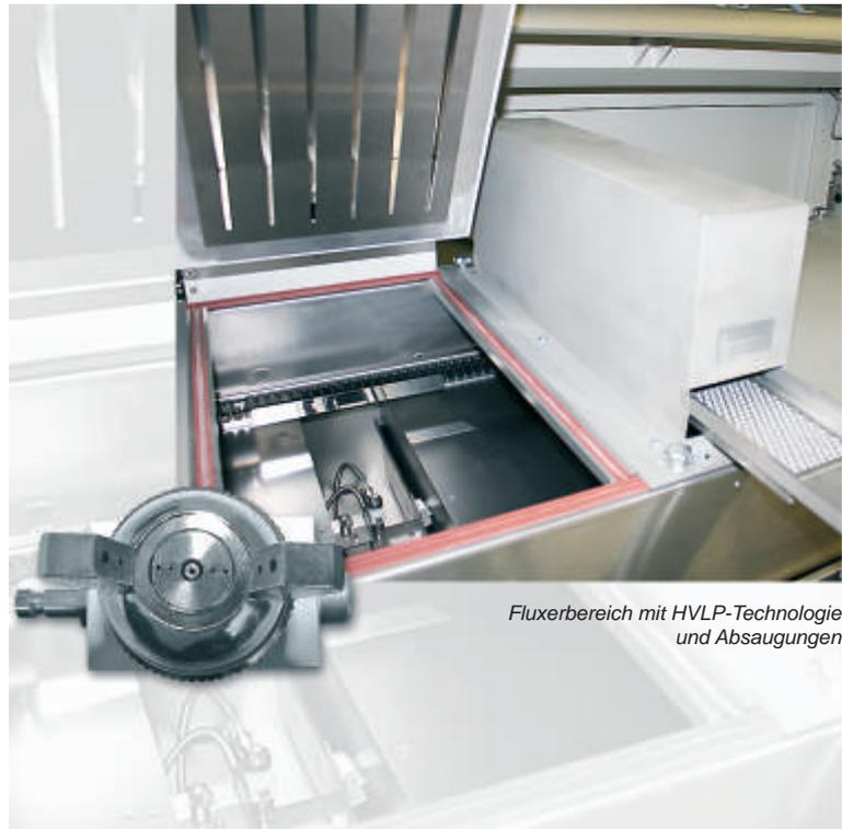
Fluxerbereich mit HVLV-Technologie und Absaugungen
