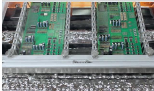
Für die effektive Reduzierung der Oxidbildung kann das Lötbad lokal mit Stickstoff begast werden. Die hierdurch erzielten Kosteneinsparungen im Lotverbrauch sind bemerkenswert. Gleichzeitig wird die Benetzung deutlich positiv beeinflusst und die Lötqualität verbessert.
