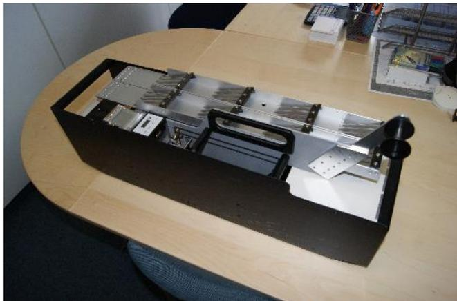
VMF30-Magazin mit Adaption und Labelfeeder fertig für den Einsatz in einem Bestückautomat von Mycronic
