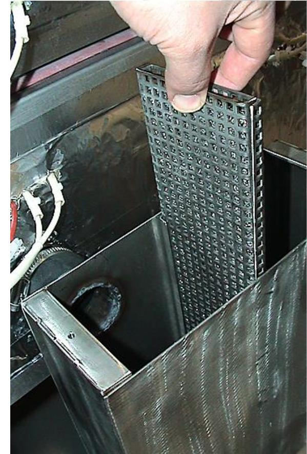
Im Bereich der Peak- und Kühlzone ist eine Prozessgasreinigung integriert.
