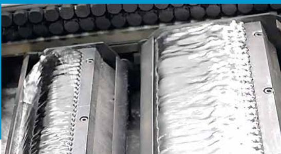
**Automatische Düsenhöhenverstellung.** In bis zu 16 verschiedenen Sektoren einer Baugruppe können die Lötdüsen softwaregesteuert einzeln in der Höhe verstellt werden, um produktabhängig immer den optimalen Abstand zwischen Leiterplatte und Lötdüse zu haben. Das ist maximale Flexibilität und maximale Prozesssicherheit!
