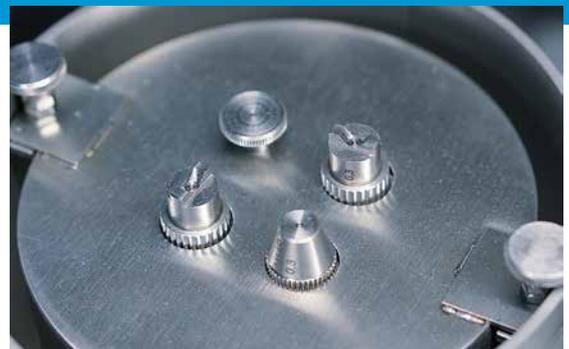
**SEHO SelectFlux.** Selektiver Flussmittelauftrag im Wellenlötprozess. Ihr Vorteil? Minimaler Verbrauch und nahezu keine Verschmutzung.
